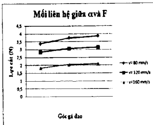
Hình 2. Mối liên hệ giữa góc gá dao và lực cắt
