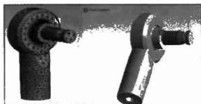
Hình 2.7. Chia lưới khớp cầu và đặt điều kiện biên
