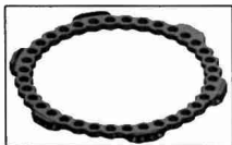
Hình 2.2. Hình dáng các vòng sau khi tối ưu trong lượng
