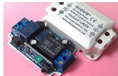
Hình 1. Module Oiovo V-86K của hãng Weivo Electronics Co.,Ltd
