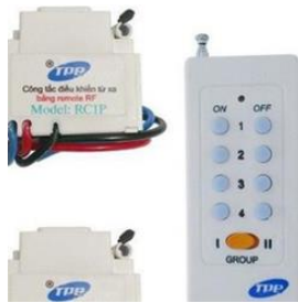
Hình 3. Module điều khiển 4 thiết bị từ xa TPP-RCIP của hãng Panasonic
