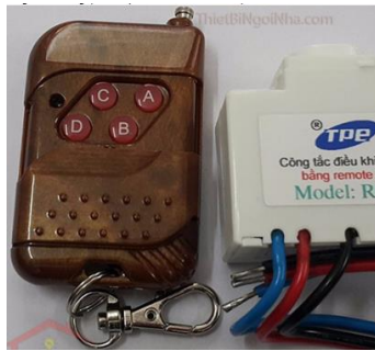
Hình 2. Module điều khiển 4 thiết bị từ xa RCIS của hãng TPE
