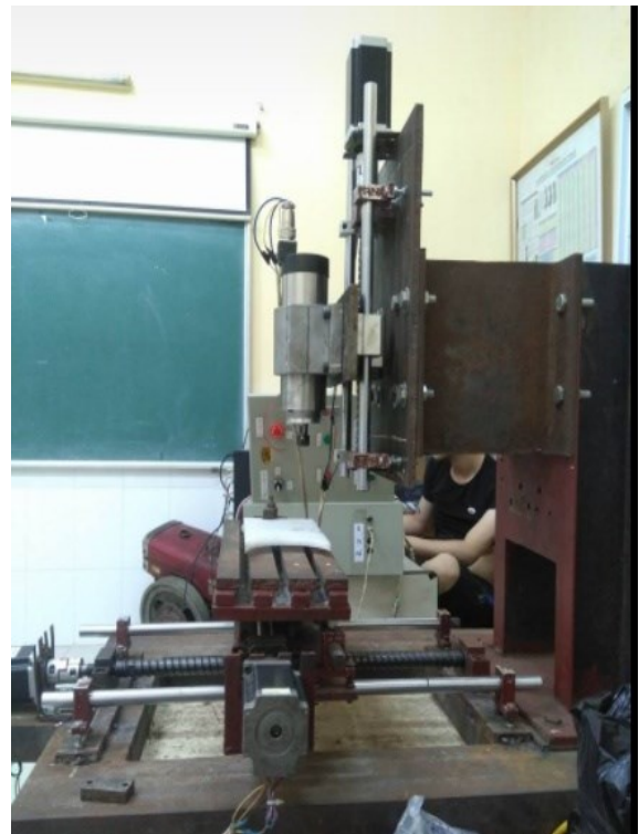
Hình 10. Hình ảnh hệ thống mô hình máy phay CNC 3 trục
