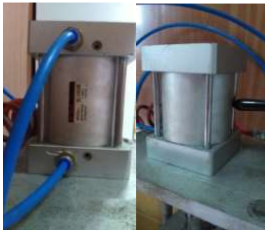
Hình 5. Hình ảnh xi lanh khí nén SC 100 × 50
