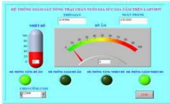
Hình 18. Hệ thống giảm nhiệt độ, tăng độ ẩm kích hoạt
