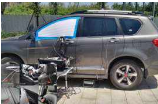
Hình 5. Lắp đặt thử nghiệm trên xe thực tế. Nhiệt độ bên trong khoang xe được theo dõi thông qua 4 cảm biến nhiệt độ bố trí tại ghế trước, giữa, ghế sau và bên hông xe [8].
