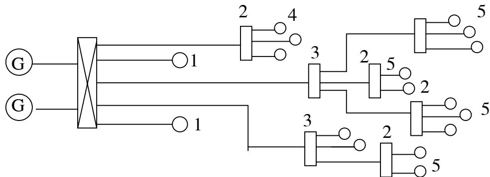
Hình 4-3 : Sơ đồ phân phối theo sơ đồ hình tia phức tạp
