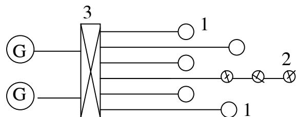
Hình 4-2 : Sơ đồ phân phối theo sơ đồ hình tia đơn giản
