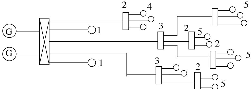
Hình 4-3 : Sơ đồ phân phối theo sơ đồ hình tia phức tạp
