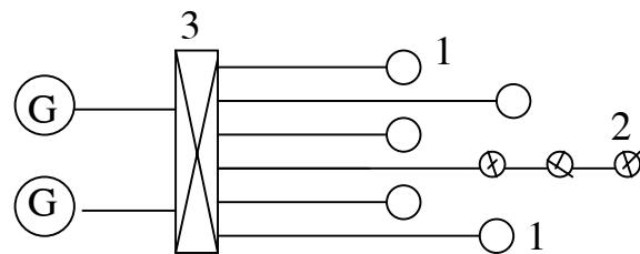
Hình 4-2 : Sơ đồ phân phối theo sơ đồ hình tia đơn giản
