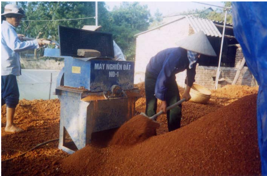
Máy nghiền của công ty.....Nhật Bản dùng cho sản xuất mùn khay.
