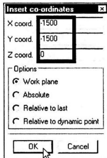
Hộp thoại **Insert co-ordinates** tiếp theo xuất hiện, nhập giá trị: X: 1500, Y: 1500, Z: 0, nhấp **OK** thực hiện lệnh. Hộp thoại **Insert co-ordinates** tiếp tục xuất hiện, nhập giá trị Z: 150 vào hộp thoại rồi nhấp **OK**.
