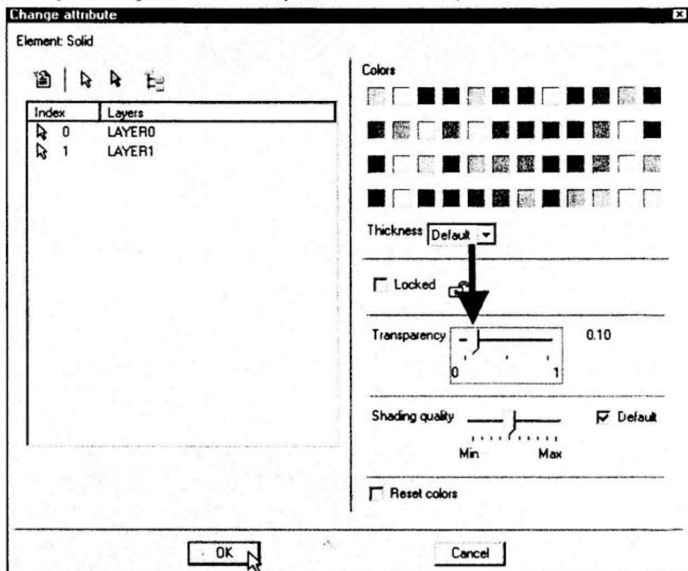
Chọn **Window > Transparent shading** trên thanh trình đơn, mô hình phôi sẽ được chuyển sang dạng trong suốt như hình.
