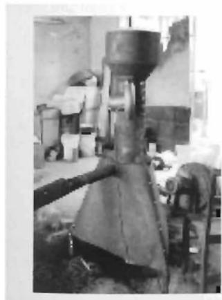
Hình 4: Lò khí hóa vô cà phê hoạt động liên tục được chế tạo tại RIAM
