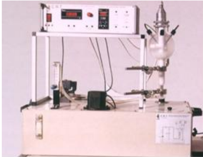
Hình 1.1: Mô hình hệ thống thí nghiệm điều khiển gia nhiệt CRT 916921
