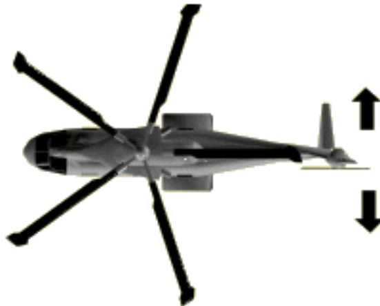
Hình 1.5. Cánh quạt đuôi sẽ tạo ra một mô men cân bằng với mômen do cánh quạt chính gây lên
